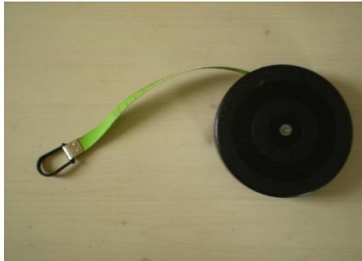
**Figura 3.6-Cordella metrica di lunghezza 20 metri**
