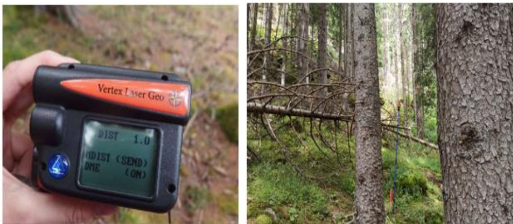
Figura 10: A sinistra il Vertex, strumento utilizzato per determinare le aree di saggio; mentre a destra il monopiede, dove è fissato il trasponder, in corrispondenza del centro dell'area di saggio.
