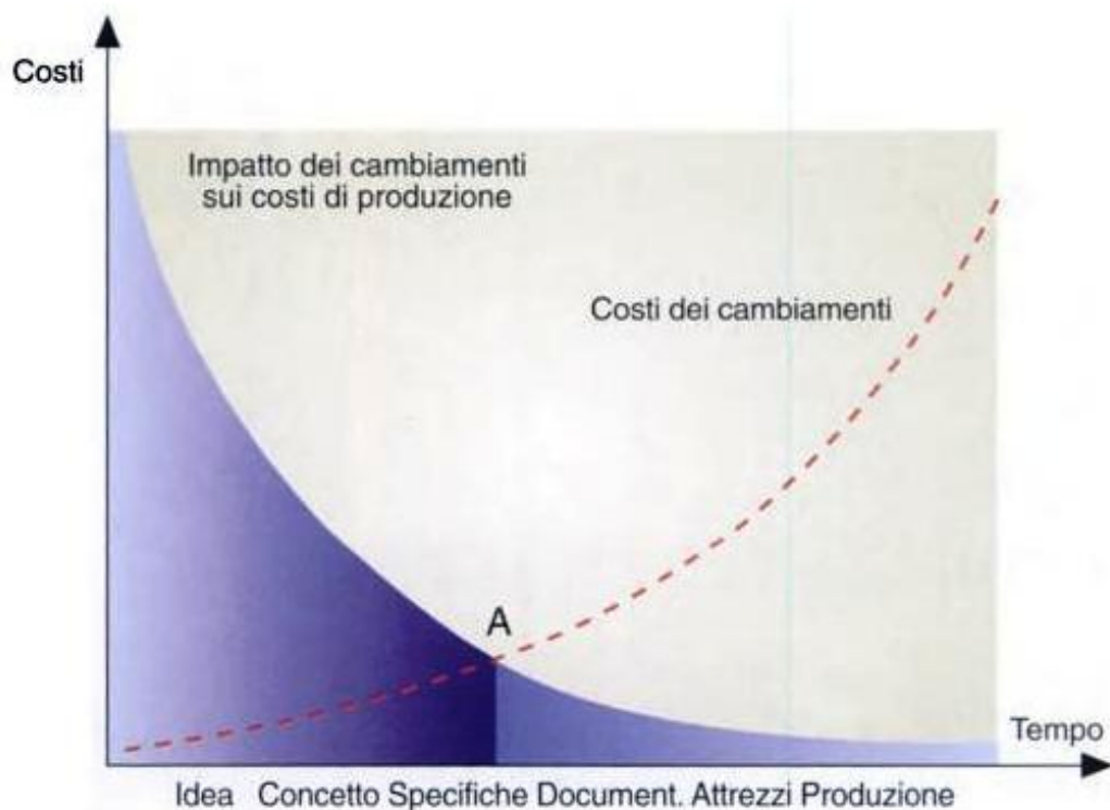
Figura 1.5 – Andamento del costo per la correzione degli errori al procedere delle fasi di sviluppo prodotto Fonte: Gatto A., Iuliano L., "Prototipazione rapida: La tecnologia per la competizione globale"
