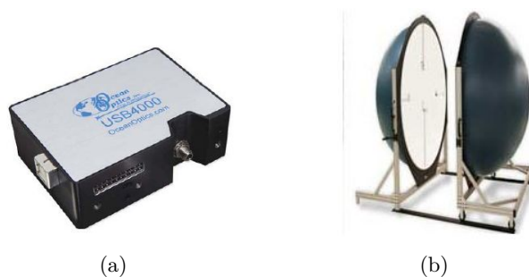
Figura 3.12: Spettrometro(a) e sfera integratrice(b)
