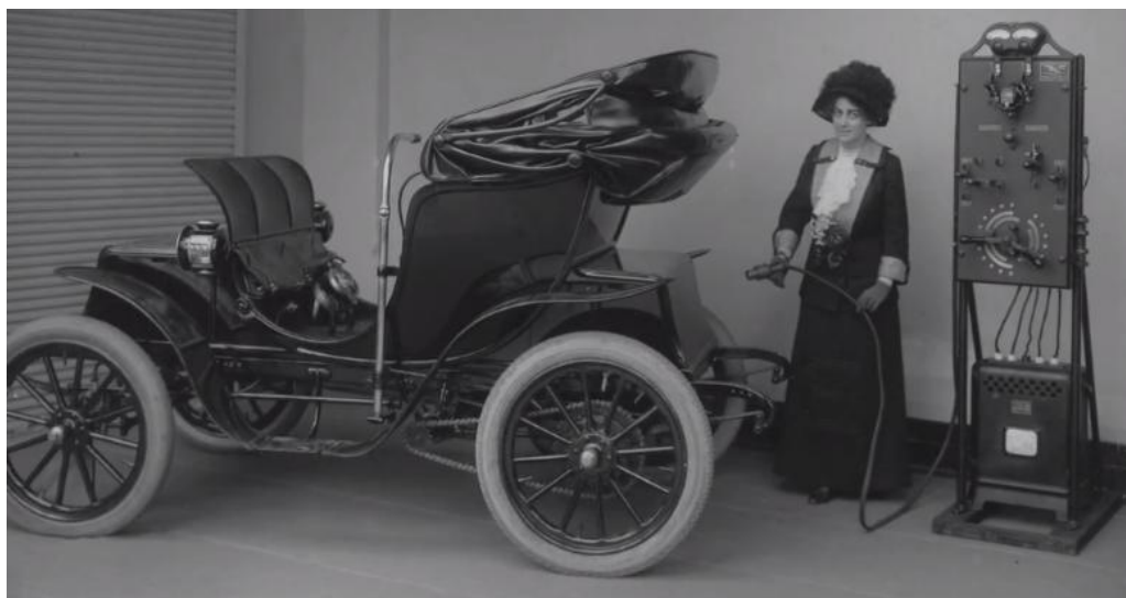
Figure 3. Signora che si appresta a collegare la propria vettura elettrica al caricabatterie
