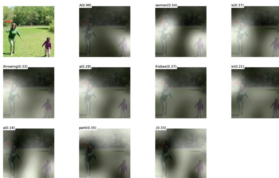
Figura 2.1 – Figura che dimostra l'utilizzo del meccanismo dell'attenzione su una immagine, le regioni sfumate in bianco indicano dove il modello pone attenzione [18]
