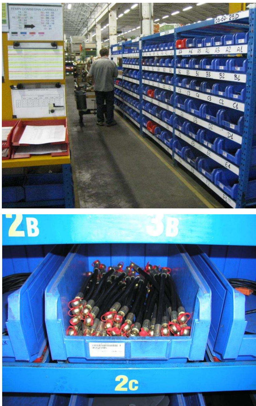
Figura 2.14: Sopra un supermercato durante il prelievo del materiale con il carrello e sotto una delle cassette in cui si vede l'ubicazione nel montante e tutte le informazioni del materiale sull'etichetta della cassetta che, di fatto, diventa la chiamata kanban verso il magazzino quando si svuota.
