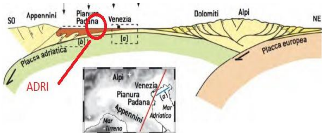
Figura 25: Sezione geologica NE-SW delle alpi meridionali, della pianura veneto-friulana e degli Appennini settentrionali. Tratta da Castellarin et al. 2006
