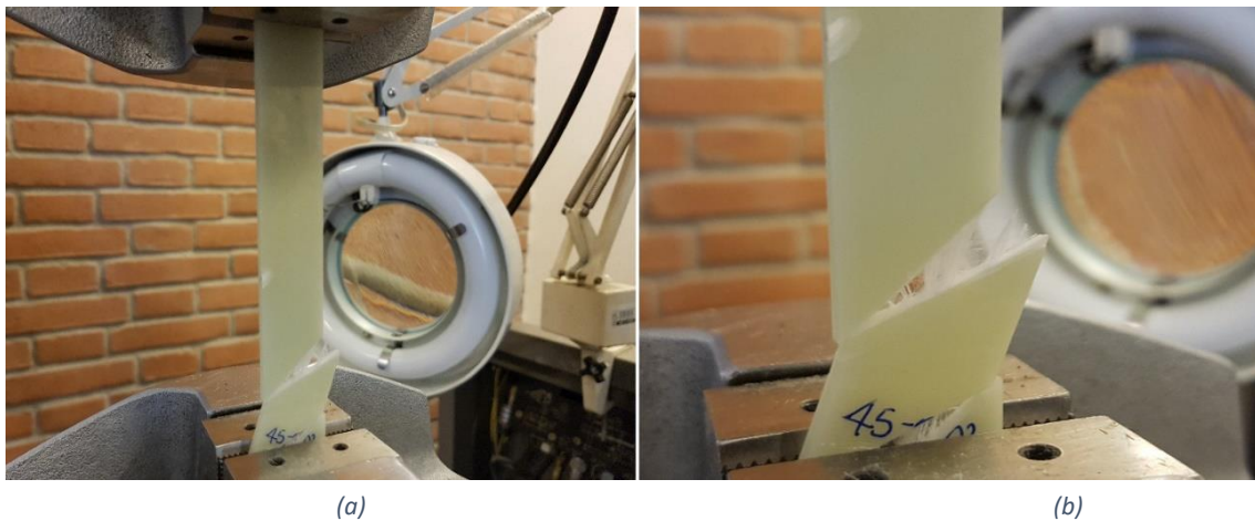
Figura 4.18 Prova di trazione su provino con fibre orientate a 45^\circ rispetto al carico. Zona di rottura all'interno dell'area di osservazione (a). Dettaglio della sezione di rottura (b)
