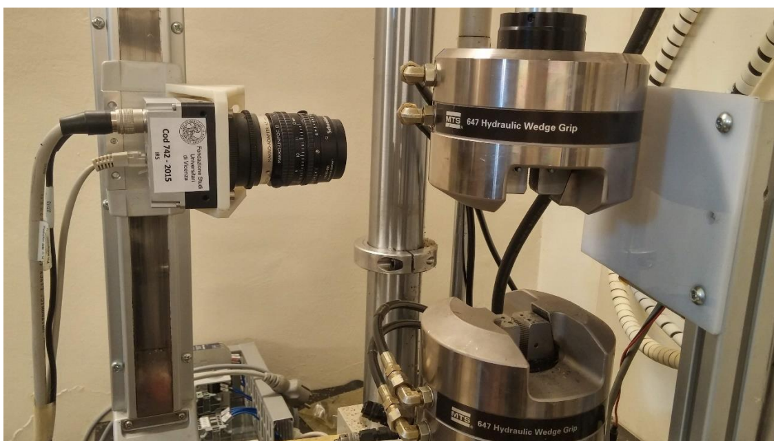
Figura 4.2 Sistema macchina di prova con camera lineare automatica
