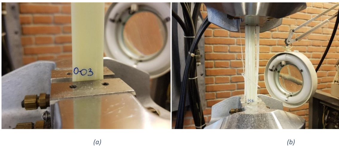
Figura 4.10 Prova di trazione su provino con fibre orientate parallelamente al carico. Formazione di cricche longitudinale sulla zona di presa (a) completo cedimento per propagazione di tali cricche (b)
