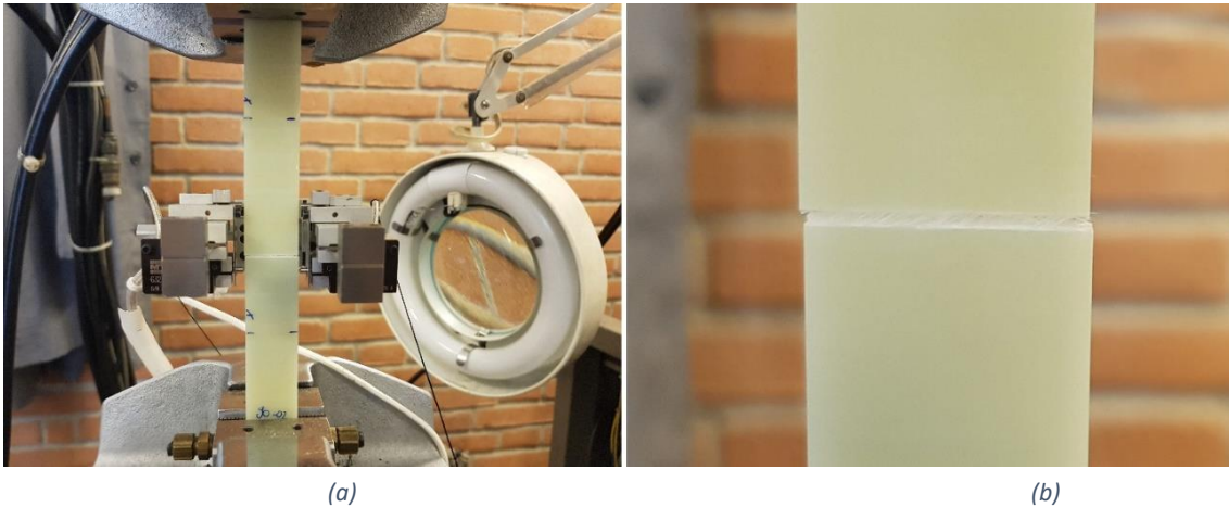
Figura 4.16 Prova di trazione su provino con fibre orientate ortogonalmente al carico. Zona di rottura all'interno dell'area di osservazione (a). Dettaglio della sezione di rottura (b)
