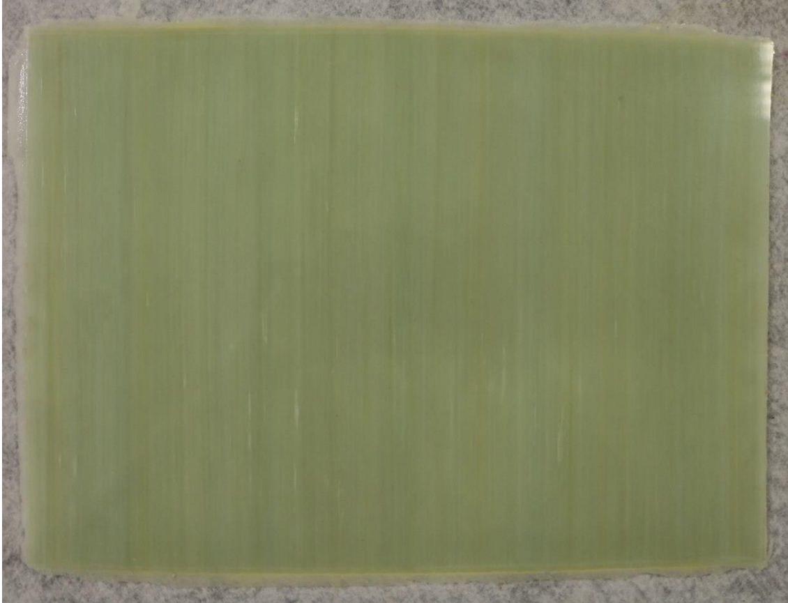
Figura 2.13 Pannello [UD] per determinare le proprietà elastiche del materiale attraverso prove statiche
