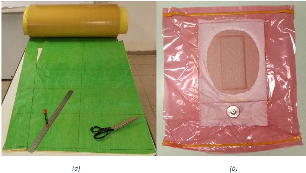
Figura 1.1 (a) Dal pre-preg unidirezionale vengono ritagliate le lamine (in questo caso con fibre orientate a 0°). (b) Sacco contenente lo stampo ed il laminato già curato (è visibile la resina fuoriuscita dal laminato attraverso il release-ply e assorbita dal distributore). Si può notare anche la valvola metallica per l'aspirazione dell'aria dal sacco tramite la pompa del vuoto.
