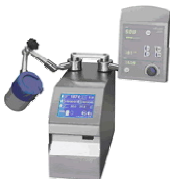
Figura 2.5: Elettronica di regolazione pompa centrifuga
