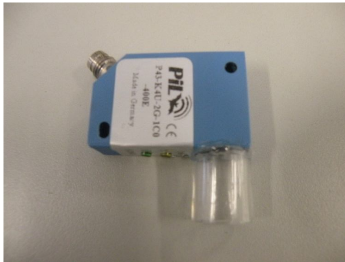
Figura 3.7: Sensore ultrasonico con applicato il tubo di collegamento al cardiotomo
