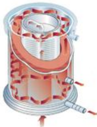
Figura 2.13: Cross-flow nell'ossigenatore PrimO 2 X
