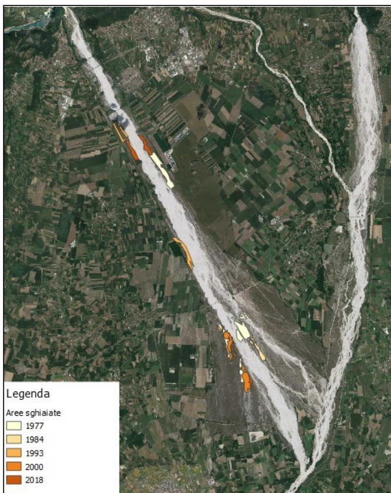
FIGURA 3. INDICAZIONE DELLE AREE SGHIAIATE E RELATIVI ANNI DI ULTIMO SGHIAIAMENTO NEL FIUME CELLINA
