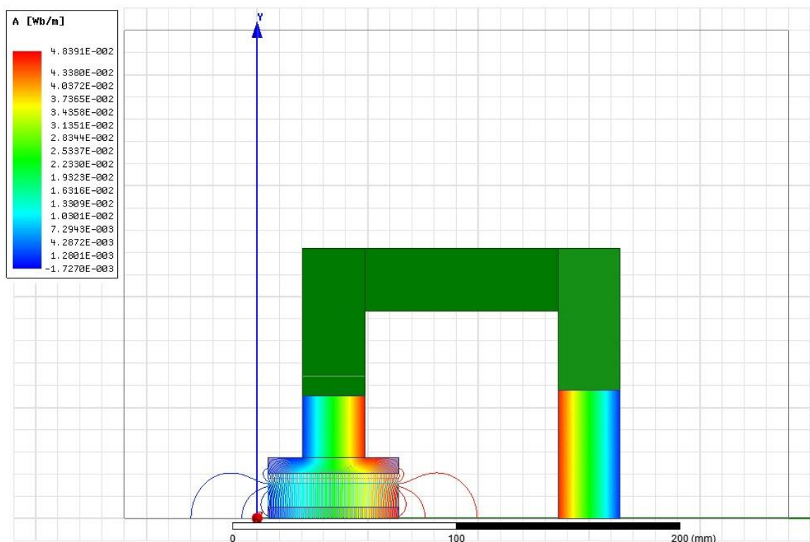
FIGURA 3-1 FLUSSO DISPERSO DAL MAGNETE NEL MOTORE 1
