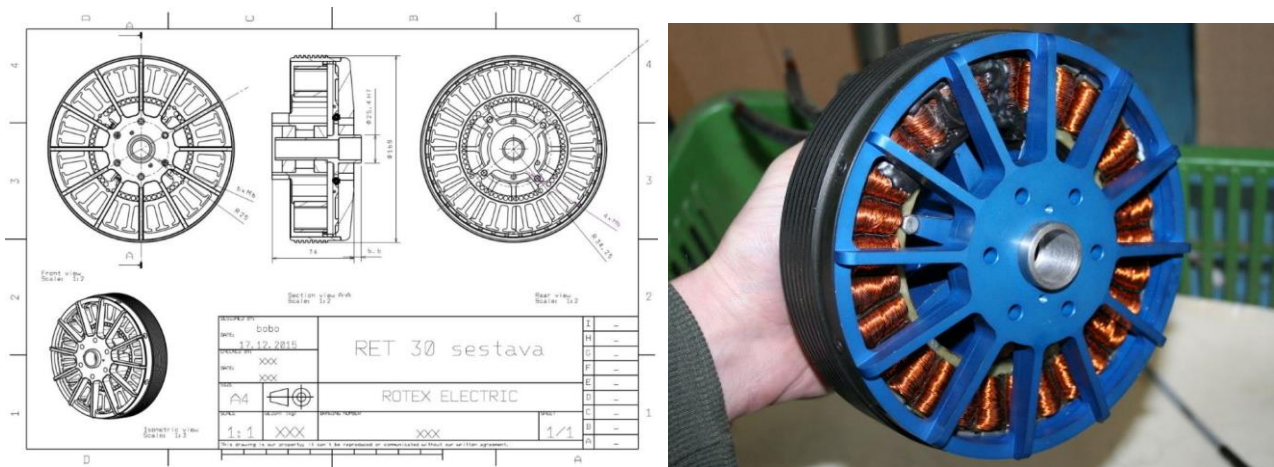
Figura 2.43 Scheda tecnica e modello realizzato del motore BLDC RET 30 della ROTEX electric (63)
