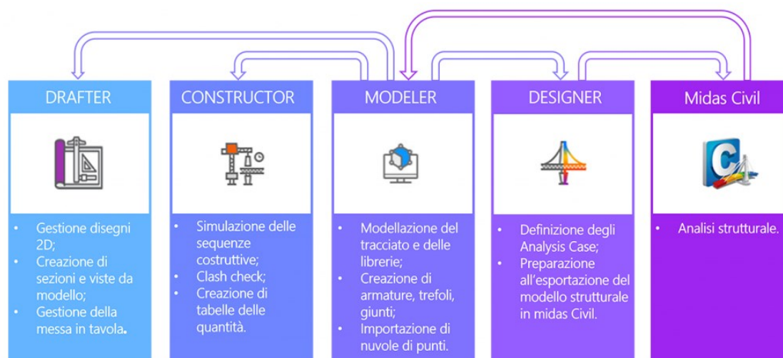
Figura 24 - Moduli interoperabili Midas CIM
