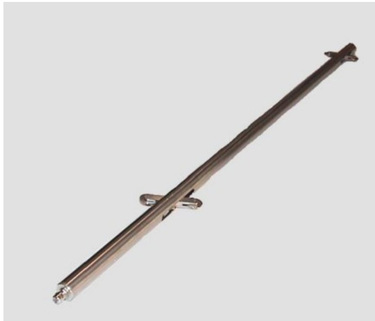
Figura 7 - Inclinometro fisso da foro
