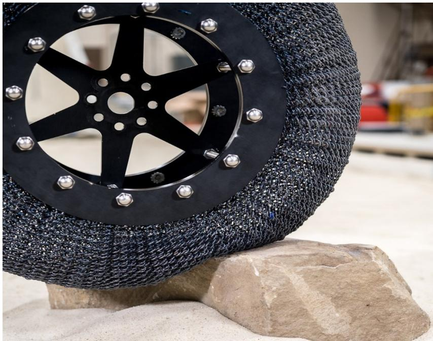
**Figura 12.** Foto di una ruota di un rover costituita da fili di Nitinol.
