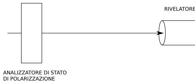
(a) Analizzatore di stati di polarizzazione con rivelatore
