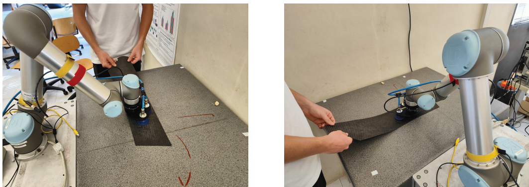
Figura 5.5: Applicazione di trasporto collaborativo, dove il robot segue i movimenti della persona in base alla lettura del sensore di forza
