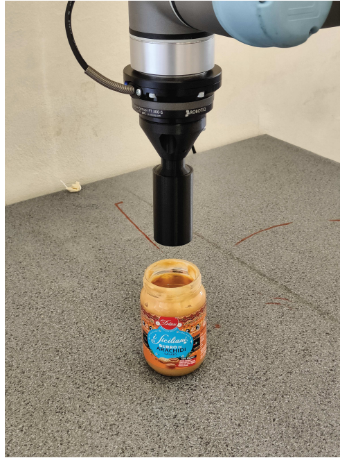
Figura 3.7: Setup sperimentale per l'analisi della precisione, composto da un vasetto di burro d'arachidi e un tool cilindrico stampato in 3D
