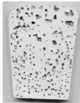
Figura 1.2: Porosità generate dalla presenza di bifilm
