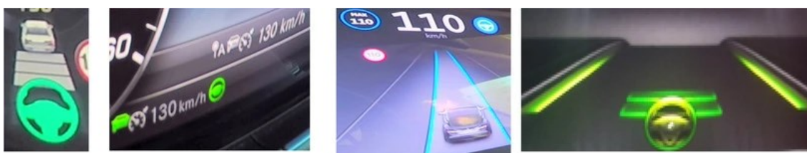
Figura 31 L'immagine rappresenta le indicazioni di sterzo autonomo attivo e rilevamento della segnaletica orizzontale di Volvo S90, Mercedes classe E, Tesla e BMW serie 7.
