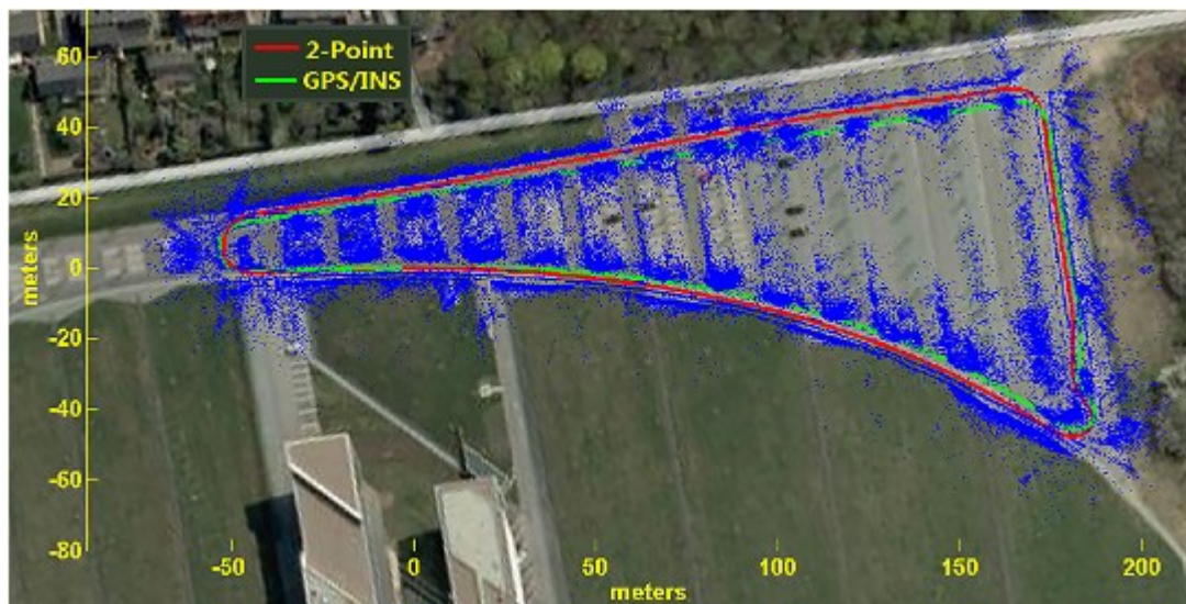
Figura 19 Vista dall'alto della traiettoria e dei punti della mappa 3D stimati attraverso l'algoritmo e confrontati con la traiettoria vera del GPS
