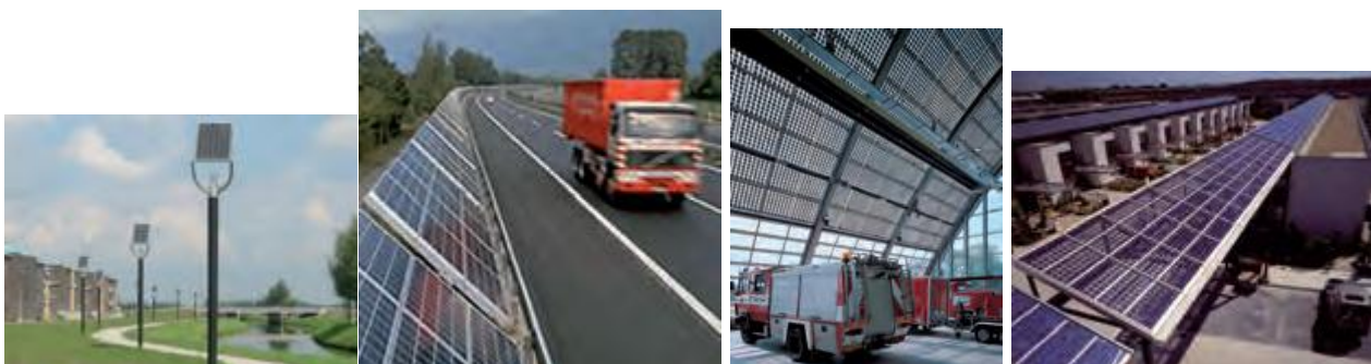
Figura 4: esempi di impianti fotovoltaici totalmente integrati (da sx illuminazione pubblica, barriere antirumore, frangisole, pensiline).
