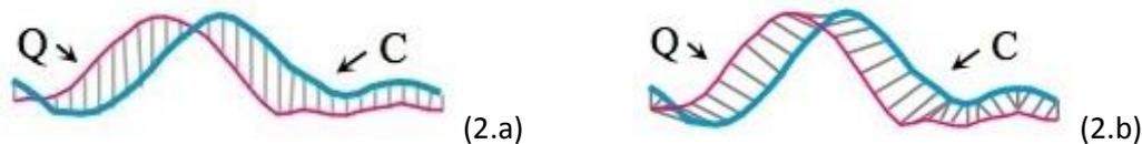
Figura 2: Rappresentazione di due serie storiche, Q e C, fuori fase in cui viene calcolata la distanza euclidea (2.a) e la DTW (2.b). Si può notare come la DTW gestisca bene il *local time shifting*, al contrario della distanza euclidea.
