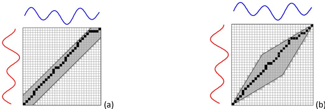
Figura 4: Illustrazione dei vincoli globali più comunemente utilizzati: la banda di Sakoe- Chiba(a) e il parallelogramma di Itakura(b).
