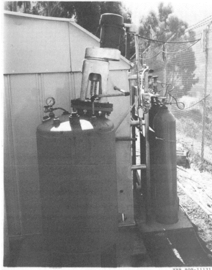
Figura 1.12: Fotografia setup di tipo Levy. Si notino le bombole e il miscelatore
