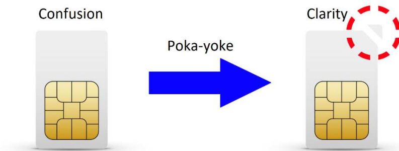
Figura 2.6: L'immagine mostra il Poka Yoke, un metodo Lean per prevenire errori, trasformando un processo da 'confuso' a 'chiaro'. Fonte: Sito Fractory.
