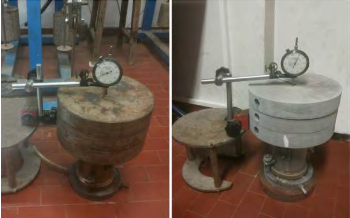
Figura 17: Consolidometro in fase di consolidazione, a sinistra, e di scongelamento, a destra.
