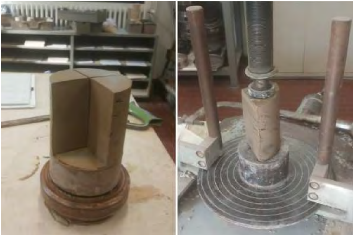
Figura 18: Taglio del terreno dopo la consolidazione nel consolidometro e preparazione del provino per prova triassiale.
