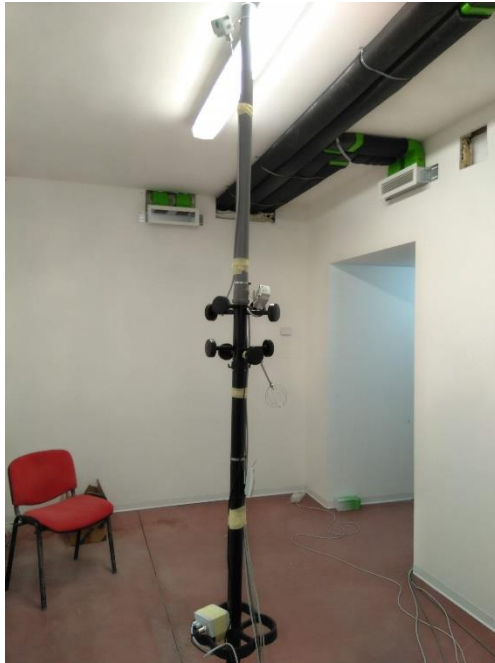
Figura 3.21 - Piedistallo per sensori di misura soggiorno. Non si tratta altro che di un appendiabiti a cui è stato infilato un tubo in plastica lungo 1,5m in testa di modo da giungere ad un'altezza sufficiente per disporre tutti i sensori centrali. Grazie agli appendini e con l'aggiunta di fascette stringi tubo si sono fissati i vari strumenti con l'ausilio di nastro adesivo e tubetti in rame a cui sono stati ancorati.
