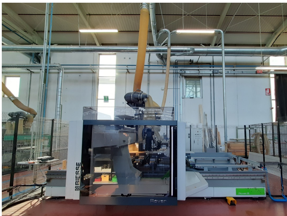
Figura 2.16 – “Biesse Rover 5 assi” del reparto “Fuori Misura” FONTE: Immagini scattate in azienda
