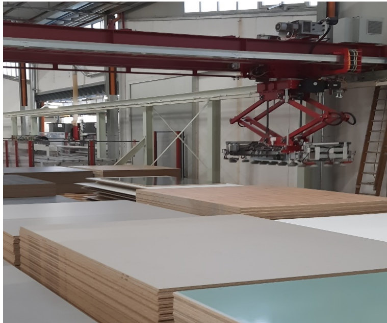
Figura 2.3 - Ponte di prelievo dei pannelli nelle baie di carico magazzino “Sirio” FONTE: Immagini scattate in azienda
