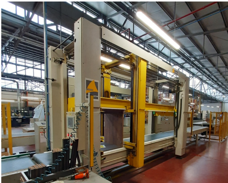
Figura 2.12 - Esempio di strettoio automatico per le linee L01-L02-L03-L04-L05 FONTE: Immagini scattate in azienda
