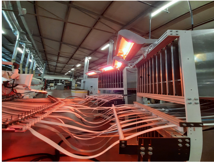
Figura 2.6 - Bobine di bordo in ingresso alla bordatrice “Novimat” riscaldate da lampade per evitare rotture meccaniche nel periodo invernale.
