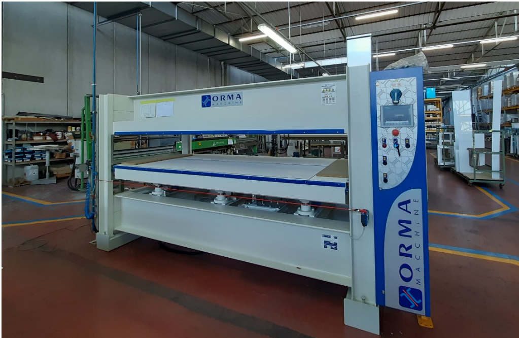
Figura 2.10 – Pressa a caldo “Orma” FONTE: Immagini scattate in azienda
