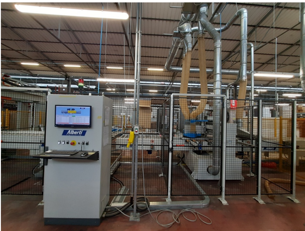
Figura 2.9 – Foratrice “Alberti” reparto colonne per lavorazione fianchi FONTE: Immagini scattate in azienda
