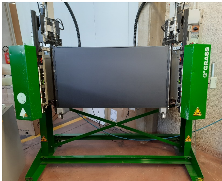
Figura 2.11 - Strettoio “Grass” per assemblaggio cassetti FONTE: Immagini scattate in azienda
