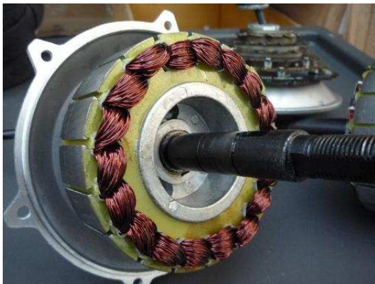
Fig. 2.12 (a): particolare di statore e avvolgimento
