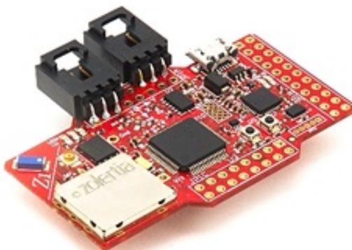
Figura 3.1: Nodo sensore Z1 di Zolertia
