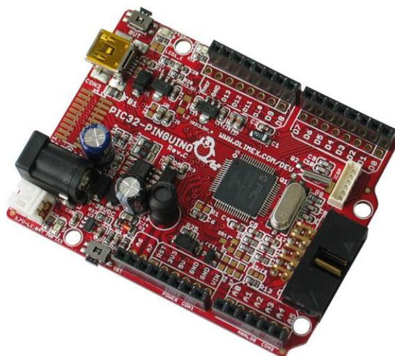
*Fig. 1 Scheda di sviluppo su cui è stato prototipato il datalogger*
