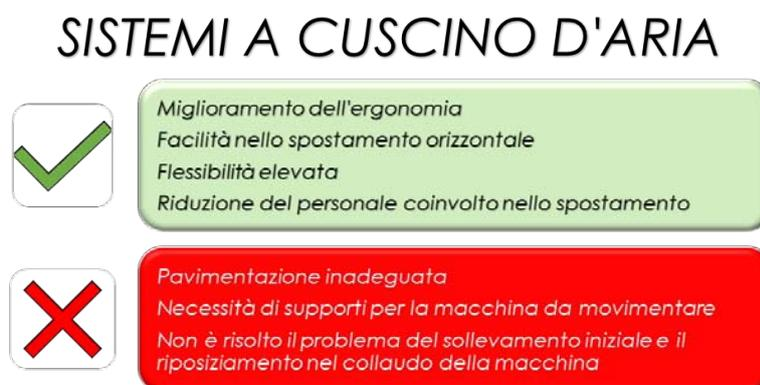
**Figura 4.19:** Benefici e svantaggi nell'utilizzo di un sistema a cuscini d'aria per lo spostamento di una RG270
