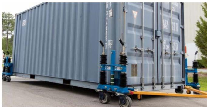
*Figura 5.1: Pattini Tandemloc impiegati per spostare un container*
