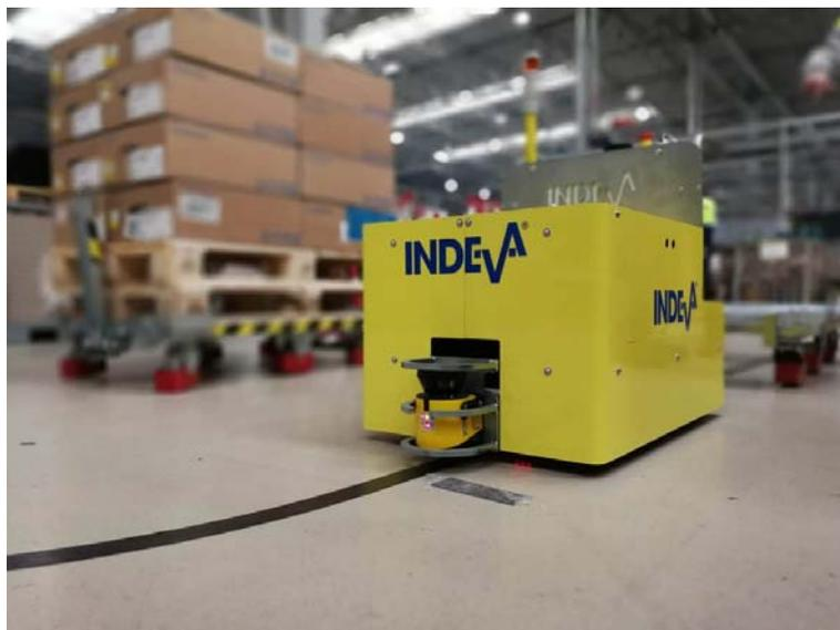
*Figura 2.6: Sistema AGV a percorso fisso*
