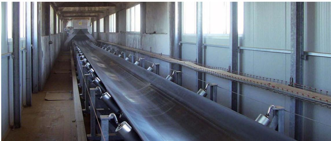
*Figura 2.4: Trasportatore industriale a nastro in tela e gomma*
