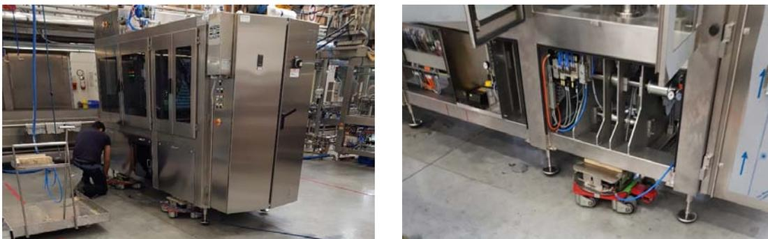
*Figura 4.2: Pattini utilizzati per l'attuale movimentazione della macchina*
