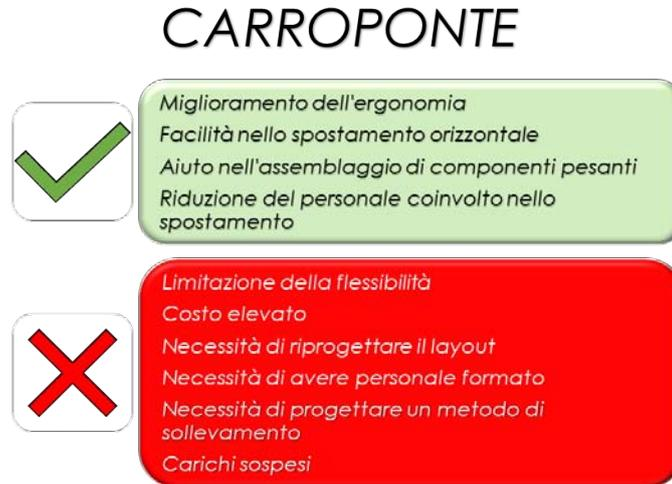
*Figura 4.11: Benefici e svantaggi nell'utilizzo di un carroponete per lo spostamento di una RG270*
