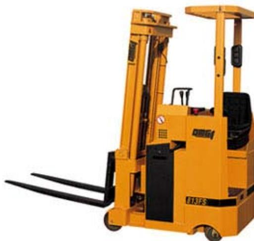
*Figura 2.2: Carrello elevatore frontale con forche a sbalzo*
