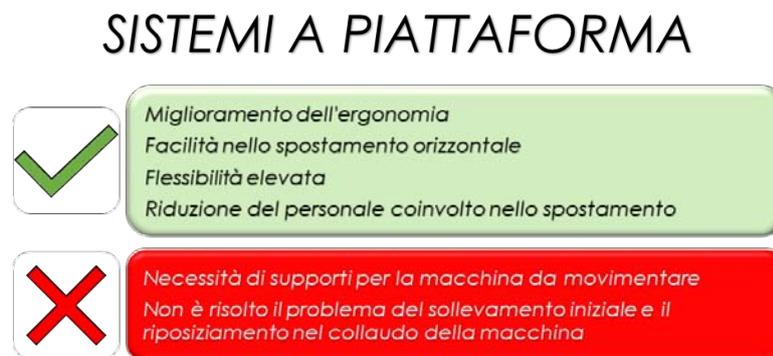
*Figura 4.23: Benefici e svantaggi nell'utilizzo di un sistema a piattaforma per lo spostamento di una RG270*
