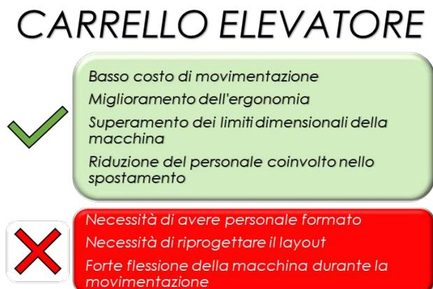
*Figura 4.8: Benefici e svantaggi nell'utilizzo di un carrello elevatore per lo spostamento di una RG270*
