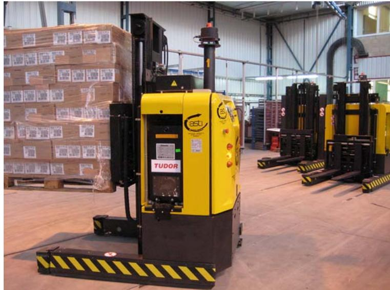
*Figura 2.7: Sistema AGV a percorso variabile*
