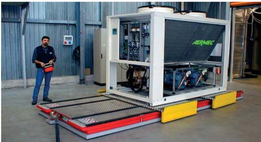
*Figura 4.17: Sollevamento di un impianto di aria condizionata tramite un sistema a cuscino d'aria.*
