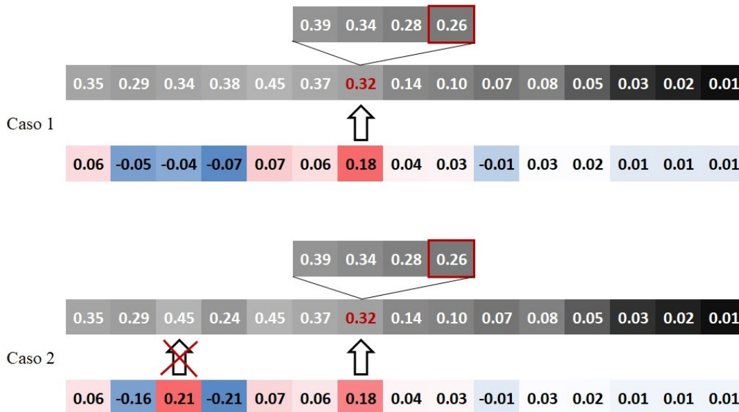
Figura 5.26: Esempi di funzionamento dell'algoritmo per l'identificazione dell'estremo superiore dello spessore del setto interventricolare.
