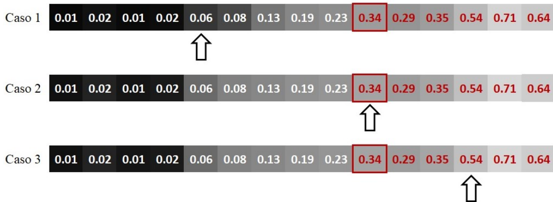
Figura 5.22: Esempi di funzionamento dell'algoritmo per l'identificazione dell'estremo superiore dello spessore della parete posteriore.
