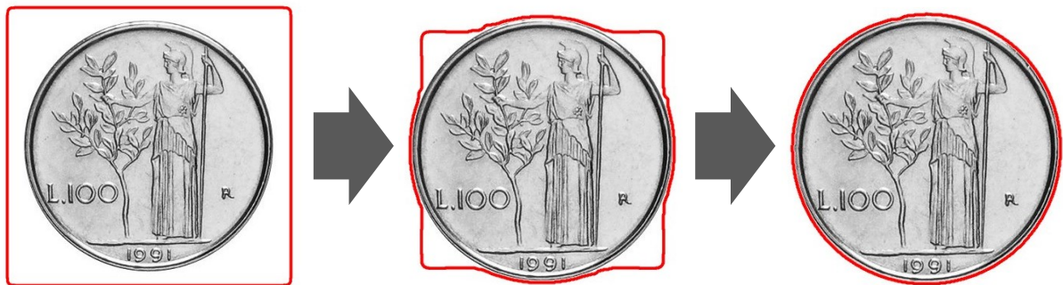
Figura 5.30: Esempio di applicazione del metodo dei contorni attivi.
