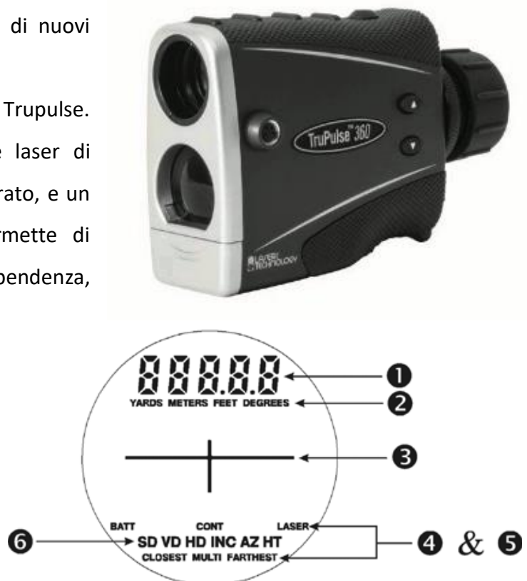
Fig. 9 – Trupulse 360 e schermata dello strumento
