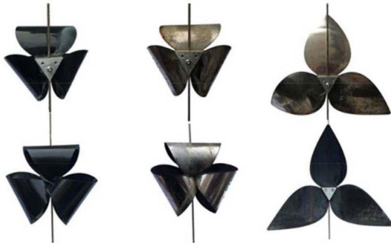
Figura 64: Rappresentazione prototipo Pho'liage in configurazione aperta e chiusa
