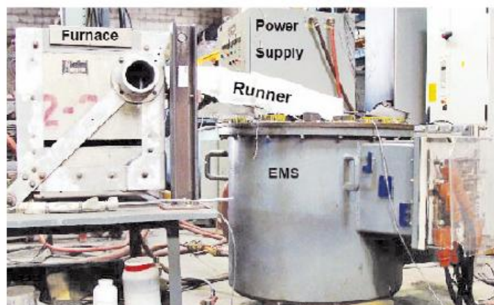
Figura 4.9. Impianto sperimentale per lo studio della lega A357
