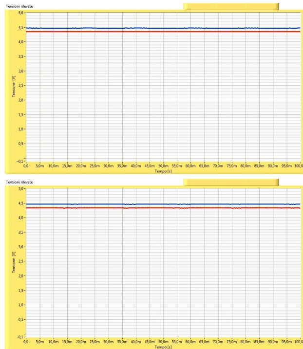
Figura 4.7: Tensioni di offset rilevate con led spenti, ed accesi (con il tubo)
