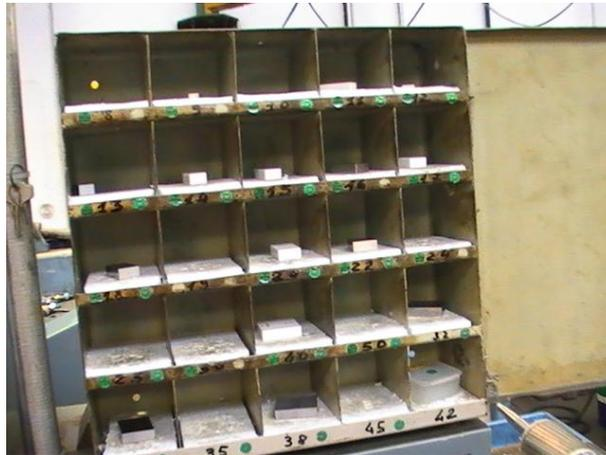
*Fig. 8.4 Armadietto contenente i blocchetti pianparalleli*
