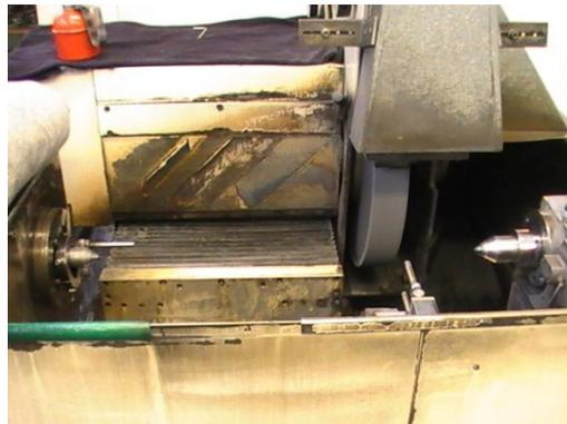
*Fig. 5.5 Differenza nel sistema di sostegno e rotazione del rotore durante la fase di lavorazione: a sinistra quello con brida pneumatica della macchina Morara e a destra quello a doppia punta della macchina Emmerre*
