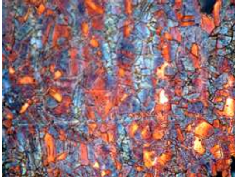
(Fig.48) attacco acido della sezione lucida , obiettivo50x.
