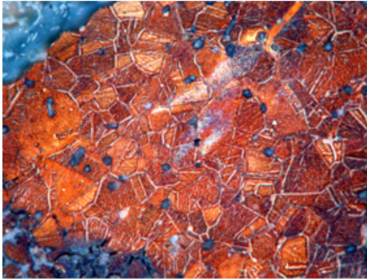
(Fig.39) attacco acido della sezione lucida, obiettivo 50x
