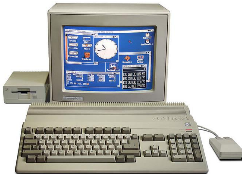
Figura 1.5 Computer Amiga 500 della Commodore, uno dei primi PC ad avere il mouse in dotazione
