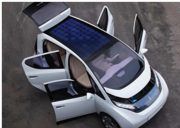
Figura 1.4: Prototipo di auto elettrica alimentata da pannelli fotovoltaici: chiaro esempio di sistema STAND-ALONE
