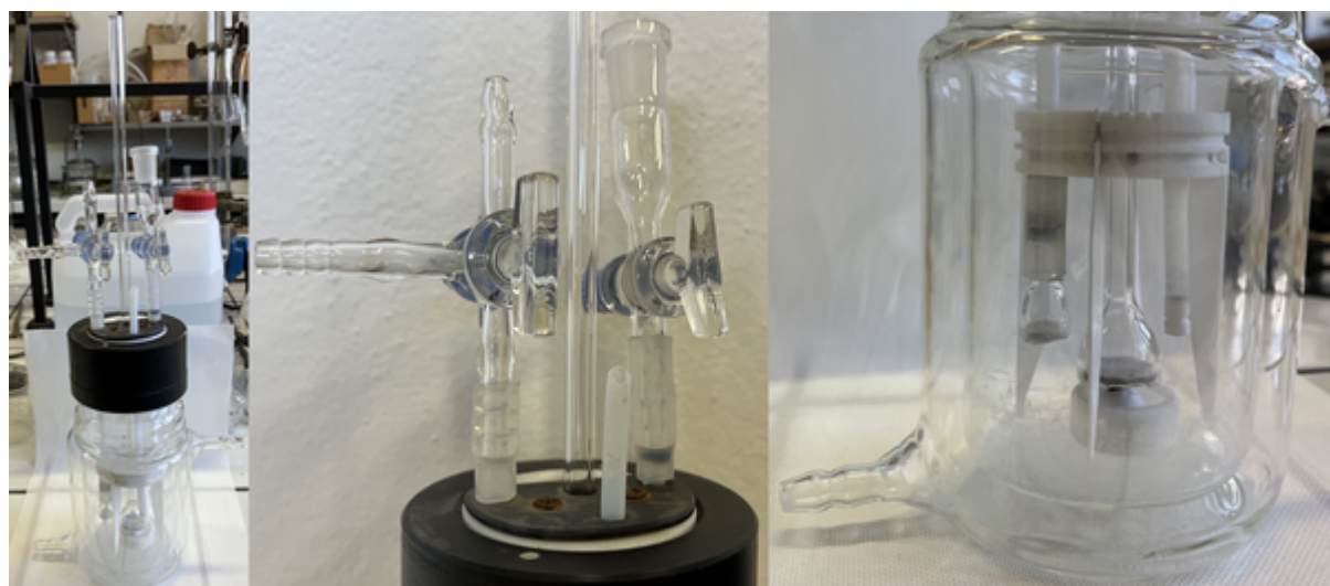
Figura 23. Reattore per la sintesi diretta (sinistra), particolare della raccordatura del reattore (centro), particolare dell'interno del reattore (destra).
