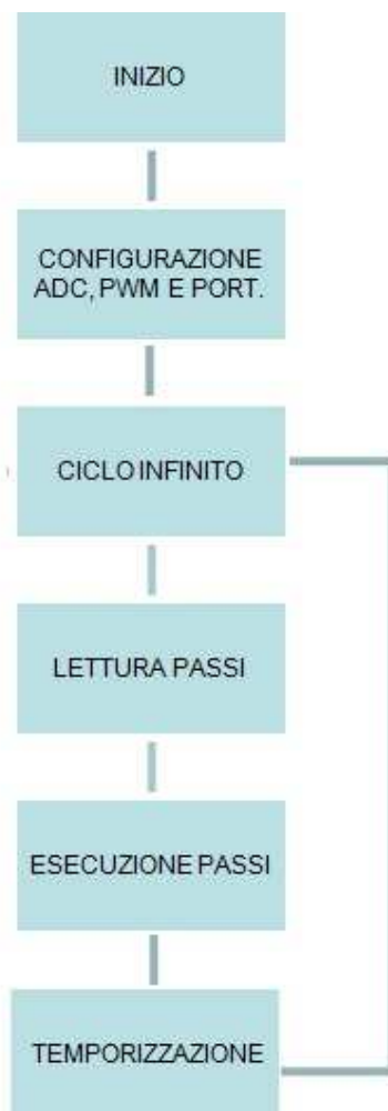
Figura 2.15: Flow chart firmware basato su ciclo while.
