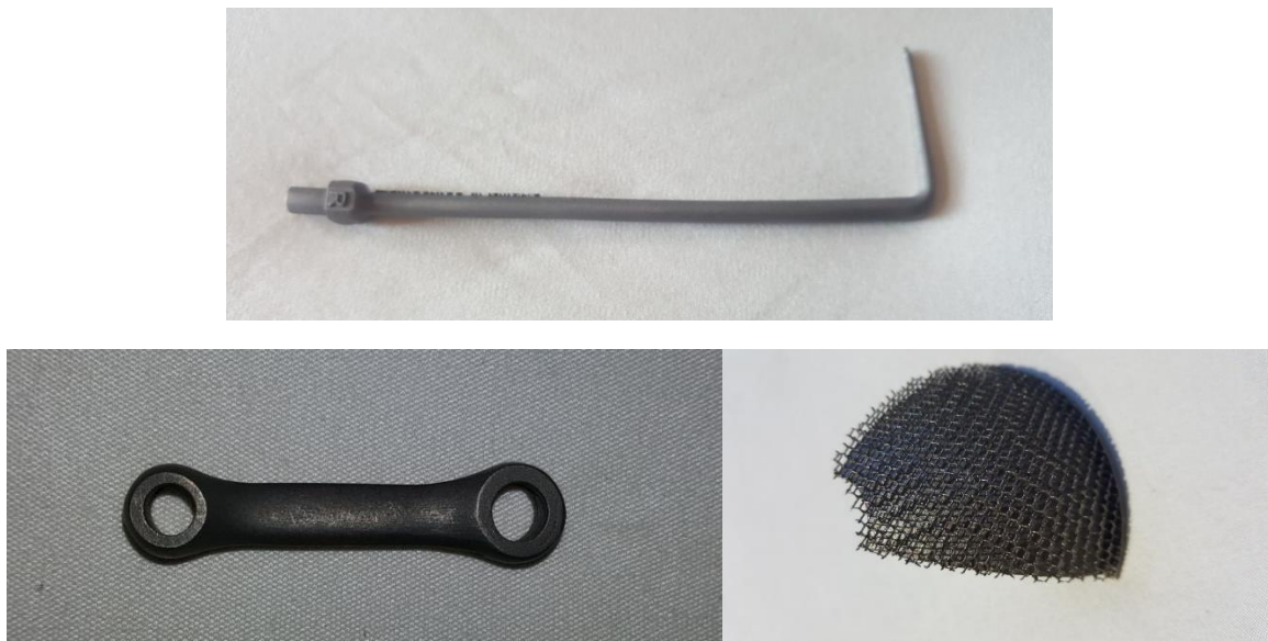
Figura 9: immagini del tubo di Pitot (in alto), della biella (in basso a sinistra) e di una protesi, in particolare una coppa acetabulare (in basso a destra).
