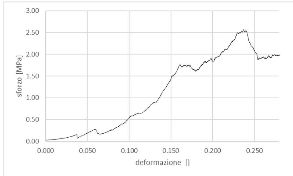
Figura 27: grafico di sforzo-deformazione per la prova di compressione
