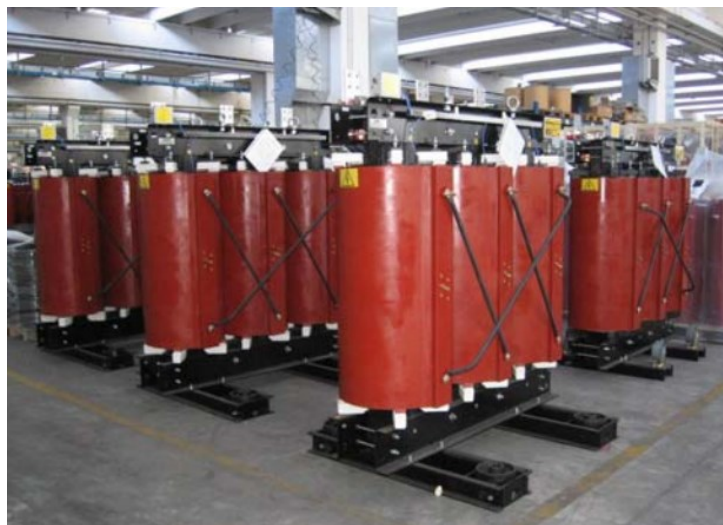
Figura 2.20: Trasformatori a secco isolati in resina 15 kV/400 V potenze 1,6 MVA e 2 MVA.
