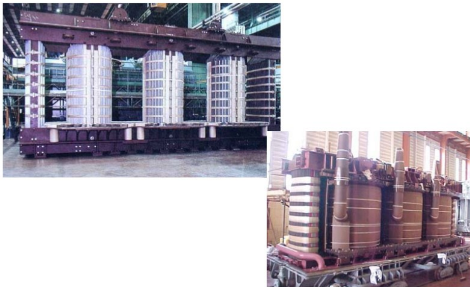
Figura 2.22: Immagini esemplificative di trasformatori trifase con nucleo a cinque colonne.
