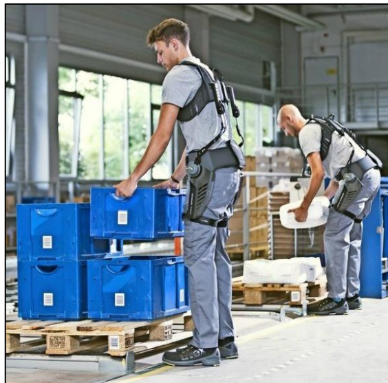
Figura 1.5. Esoscheletro Paexo Back utilizzato in ambito industriale
