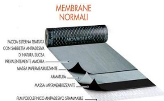
**Figura 1.2** Membrana Novaglass - Senza graniglia
