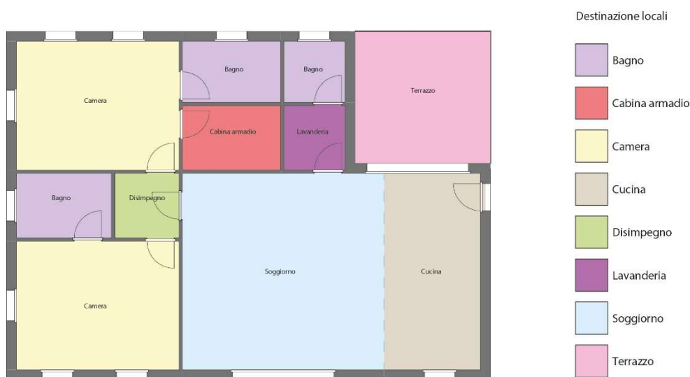
Fig. 13 - Risultato dell'associazione dei locali in Revit
