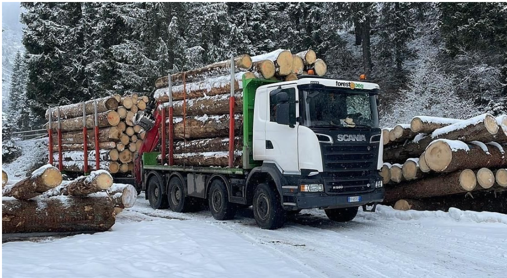
Figura 4.7: Autotreno dotato di gru adibito a trasporto legname
