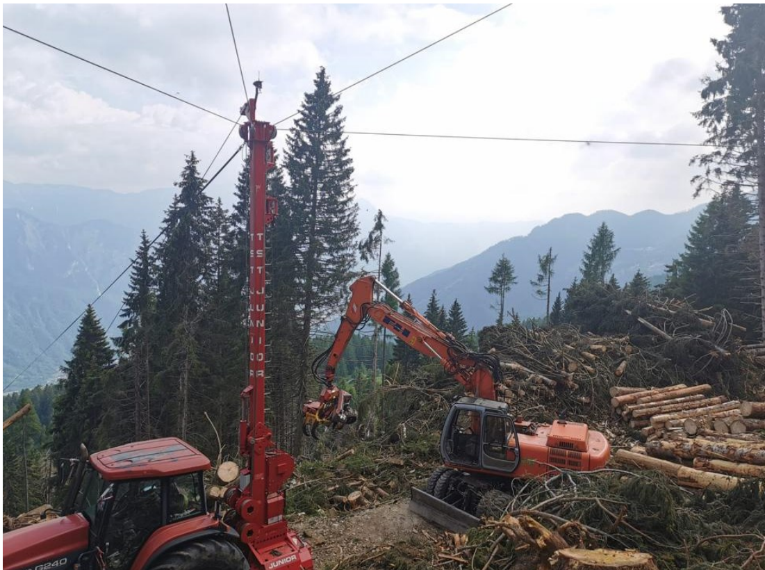
Figura 4.5: Cantiere forestale con gru a cavo trifune montata su trattore ed escavatore con testata processor
