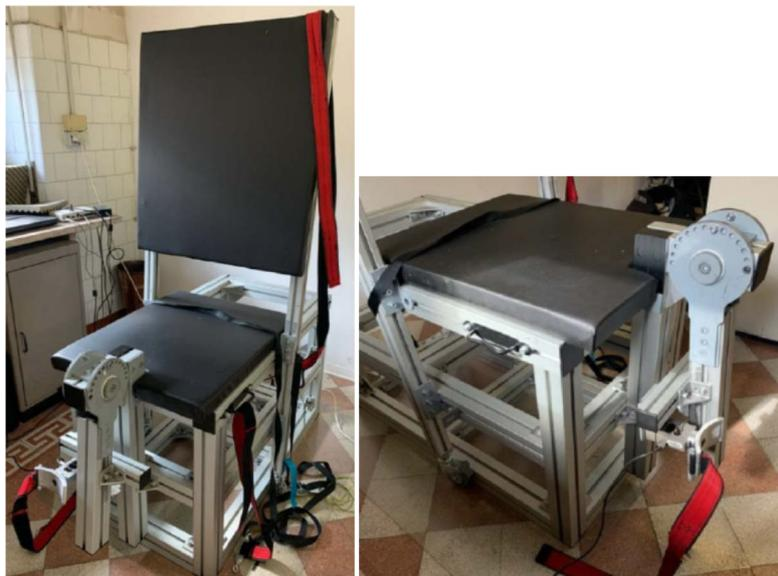
Figura 2. Dinamometro isometrico utilizzato durante il protocollo di valutazione neuromuscolare, per la misura della forza volontaria isometrica (massima e sub-massimale) in estensione di ginocchio, durante la registrazione del segnale HDsEMG.
