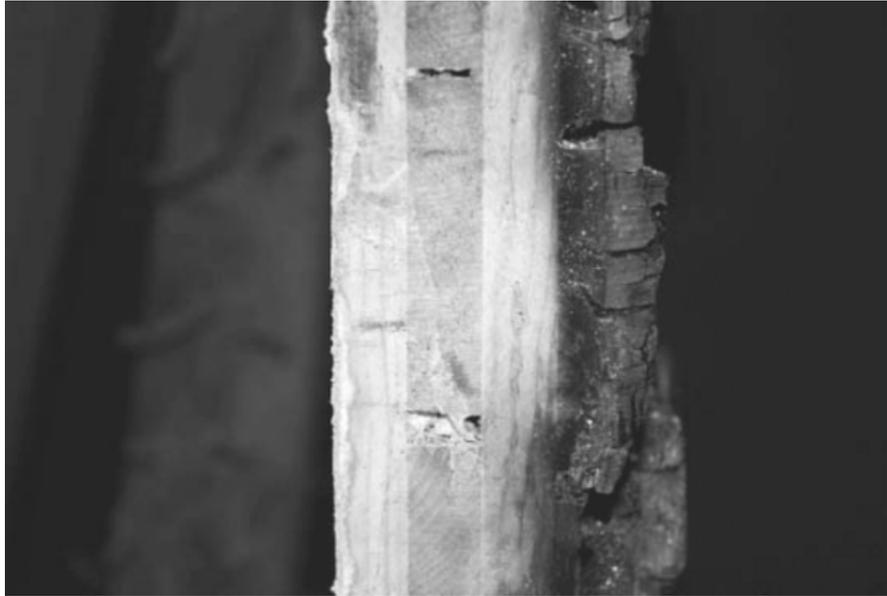
Fig. 9.2.2 Pannello a strati incrociati da 85mm sottoposto alla prova d'incendio (FOLLESA M., 2009, Linee guida per l'edilizia in legno in Toscana, Edizioni Regione Toscana)
