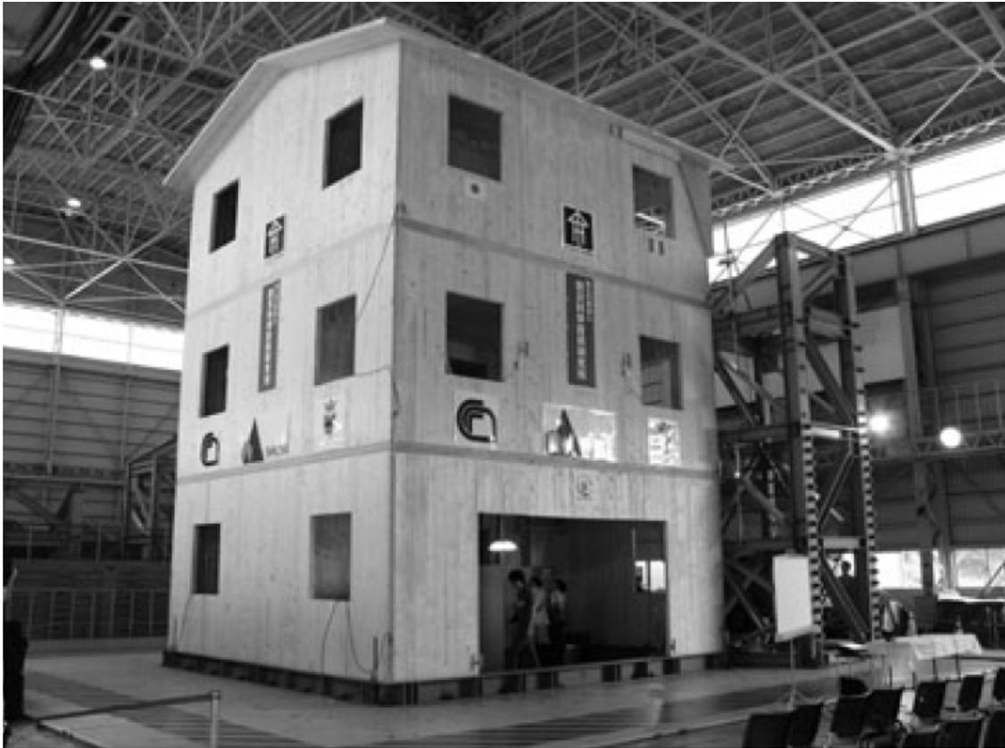
Fig. 9.3.1 Prova su tavola vibrante su un edificio a struttura di legno a pannelli portanti di 3 piani effettuata nel 2006 dal CNR-IVALSA in collaborazione con il National Institute for Earth science and Disaster prevention s Tsukuba, Giappone.
