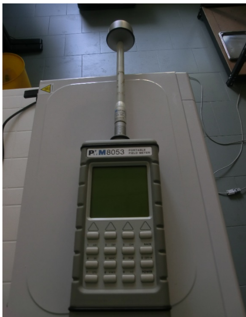
Fig. 4.3 Lo strumento utilizzato per le misure Narda PMM 8053, con sonda EP-330
