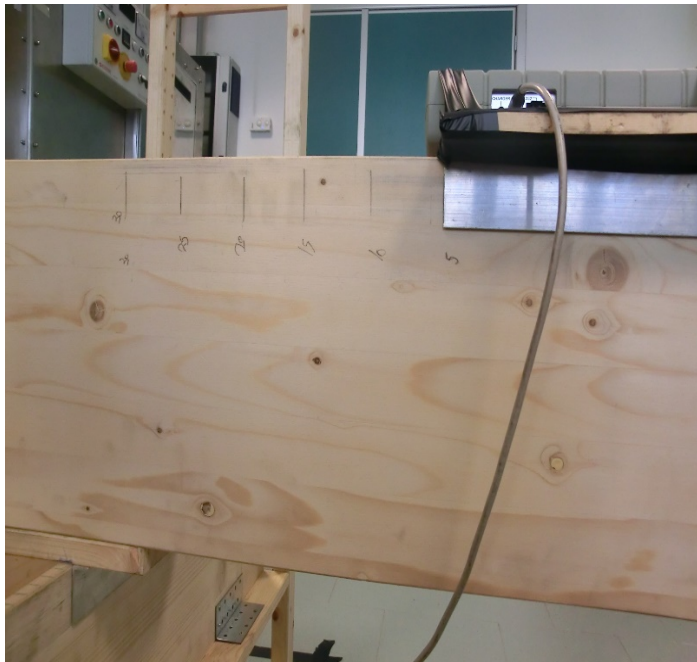
Fig. 4.12 Particolare della struttura: superficie divisa in zone di misura
